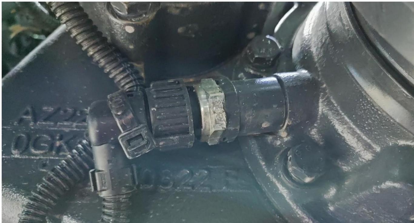
Датчик движения имеет два импульсных выхода, один из которых идёт на приборную панель, другой на тахограф.
