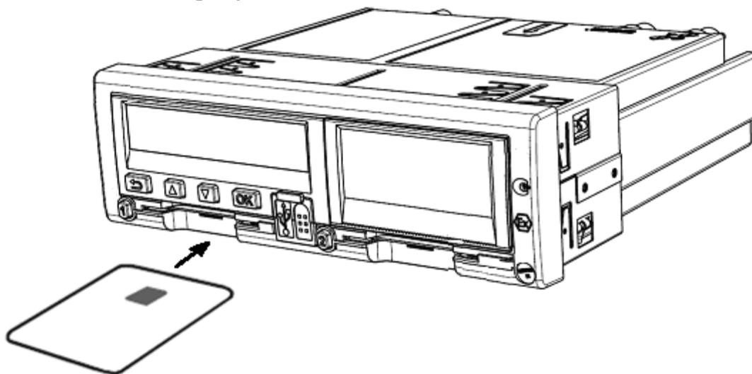
Рисунок 3 – Установка карты водителя в слот «Основной водитель»
