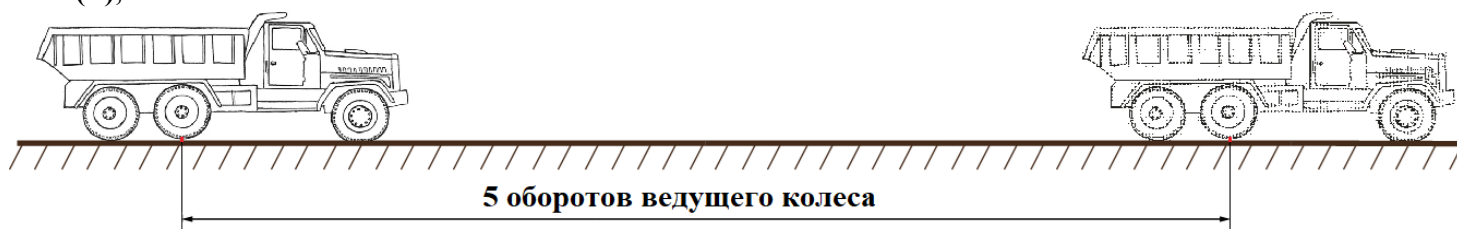
Рисунок 18 – Эмпирическое измерение эффективной окружности шин
