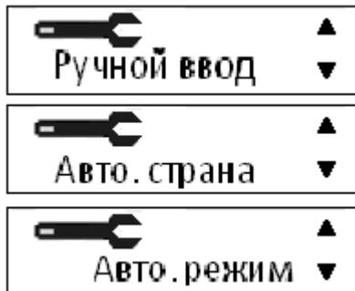
При выборе параметра «Ручной ввод» с помощью кнопок или можно установить таймаут ручного ввода (1, 5, 10 или 20 мин). Для сохранения установленного значения нажмите . После этого следует автоматический возврат в меню «Параметры».
