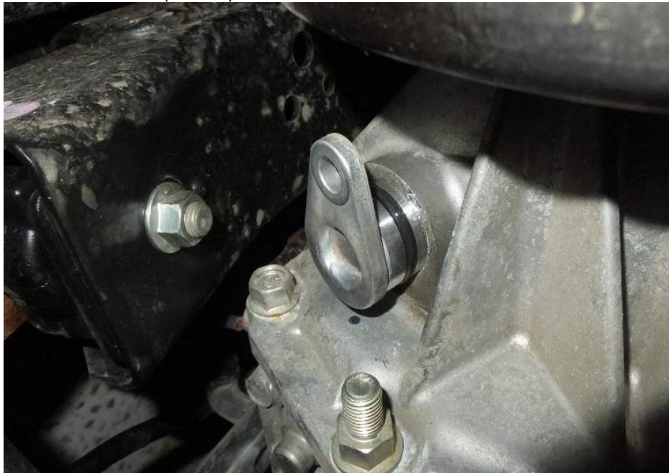
Рис. 13. Внешний вид заглушки в задней крышке коробки передач.
