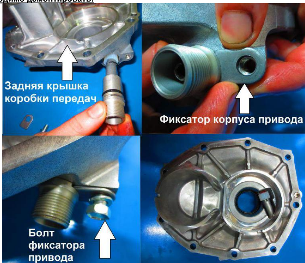
Рис. 10. Установка привода датчика скорости в заднюю крышку коробки передач.
