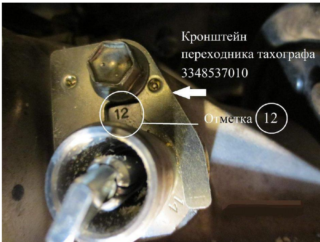
Рис. 15. Корректная установка привода датчика скорости.
