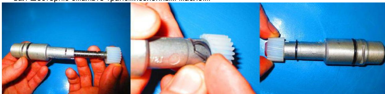
Рис. 9. Сборка привода датчика скорости.
