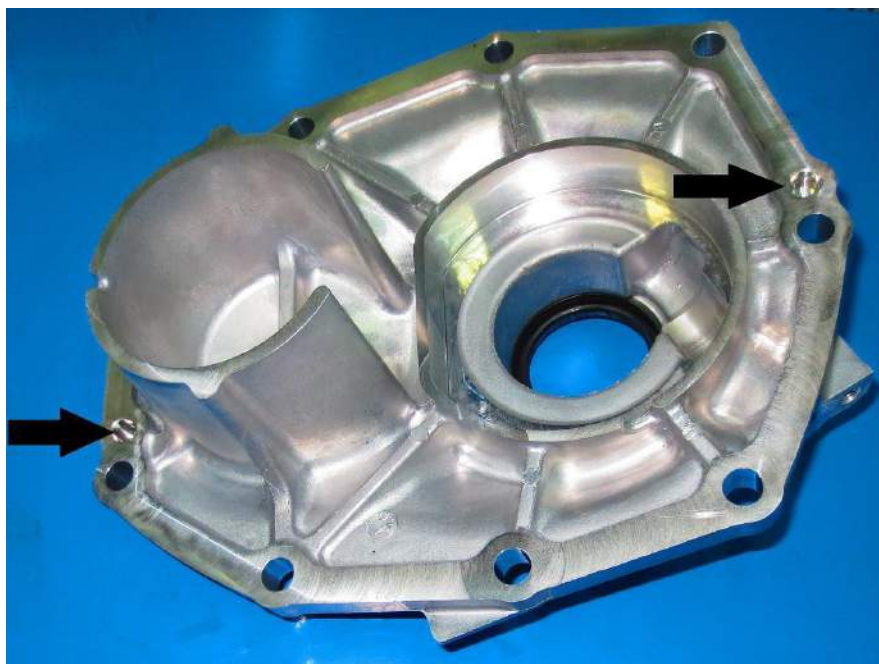
Рис. 11. Места установки направляющих штифтов.
