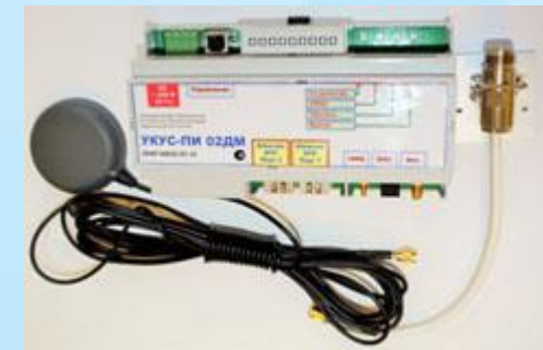
устройство выдачи шкалы UTC(SU) с индикатором времени
